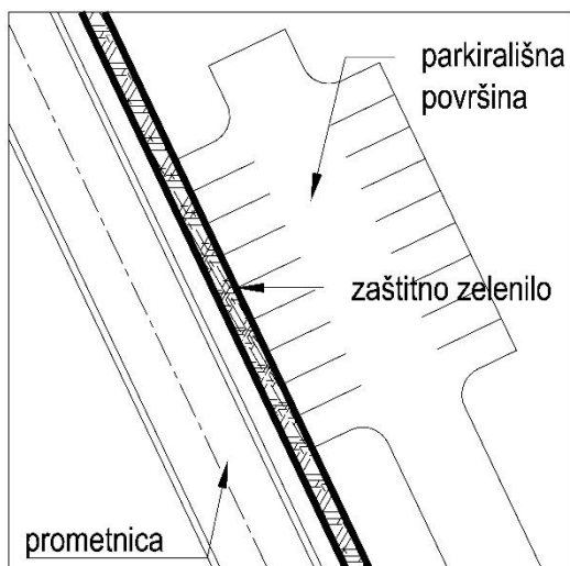
Slika 3: primjer obveznog utvrđivanja zaštitnog zelenog pojasa između parkirališne površine i regulacijskog pravca
